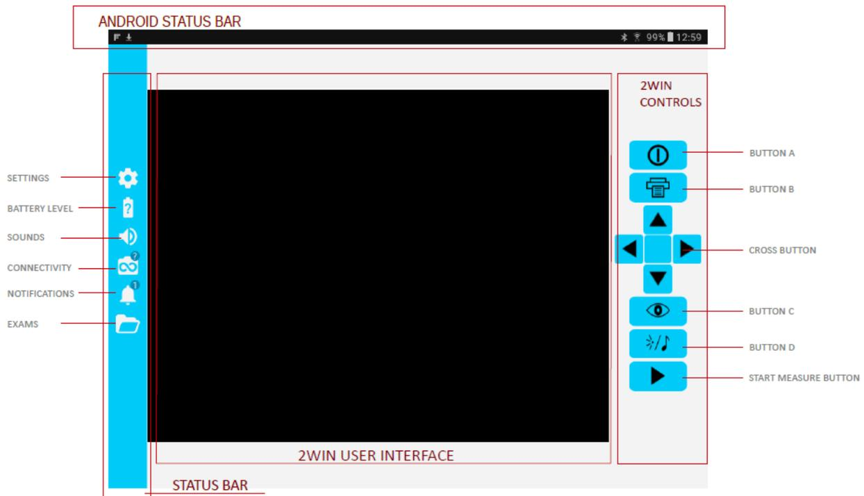
Die Tasten auf der rechten Seite der 2WIN App-Verbindung Wi-Fi sind die Nachbildung der 2WIN Tasten, so dass die Funktionen der physischen Tasten von 2WIN von der App gesteuert werden.
