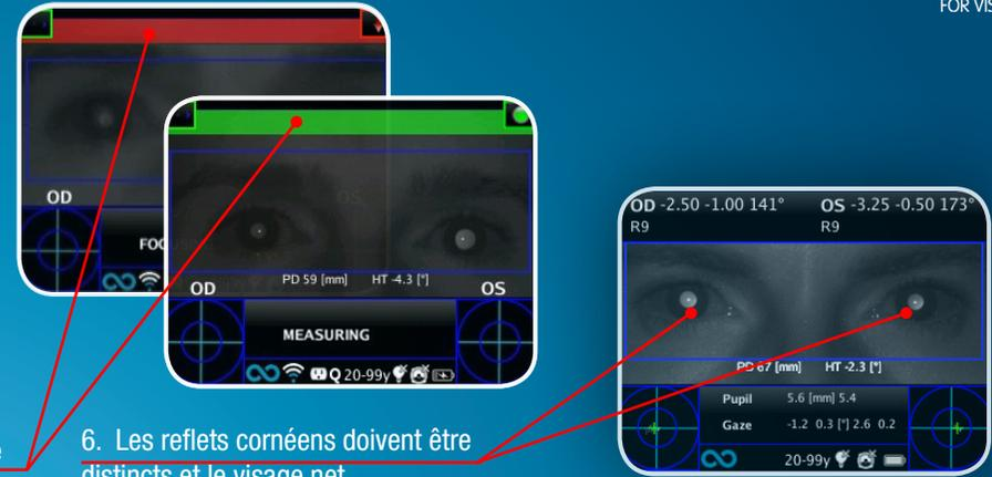
5. Adaptez la distance de prise de mesure jusqu'à ce que la barre supérieure soit verte en permanence
