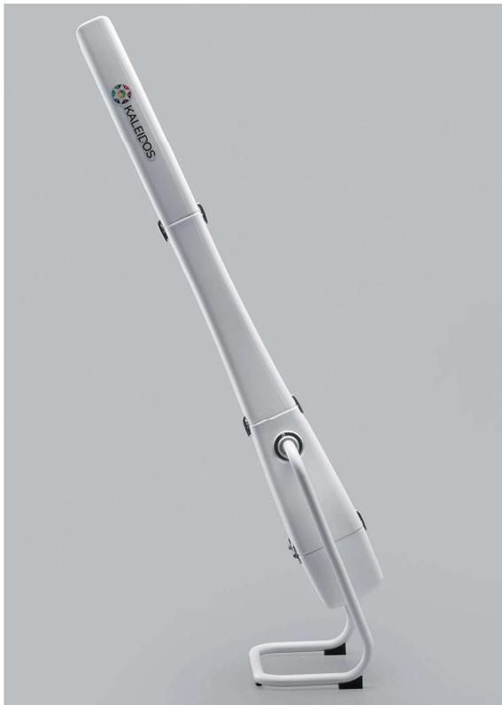
Lo strumento, prodotto da Adaptica, è realizzato tramite stampaggio rotazionale a doppia carica in PE. I componenti metallici – acciaio e alluminio anodizzato – sono stampati e tagliati a laser.
