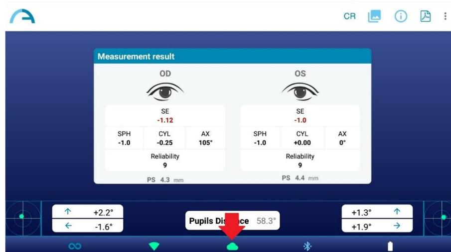
Se il 2WIN-S non è in grado di misurare la refrazione del paziente e viene rilevata qualsiasi possibile anomalia del segmento anteriore, viene segnalato all'operatore l'avvertimento "Possibile anomalia del segmento anteriore" ("**Possible anomaly of the Anterior Segment**") con l'indicazione dell'occhio (sinistro, destro o entrambi).
