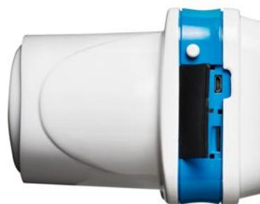
Dentro da porta de conexão USB e SD há uma porta Micro-USB que conecta a câmera 2WIN ao tubo KALEIDOS e um suporte de cartão MicroSD.
