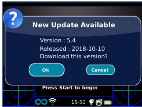
Si rechaza la actualización presionando CANCELAR, el mensaje desaparecerá hasta la próxima comprobación de actualización; si desea actualizar su 2WIN-S, presione OK y la descarga del software comenzará.
