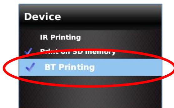
2 Emparelhe o dispositivo 2WIN com a sua impressora BT. Vá para **Menu > Configurações > Bluetooth > Configuração Bluetooth**, selecione sua própria impressora e pressione o botão central do JOYSTICK.
