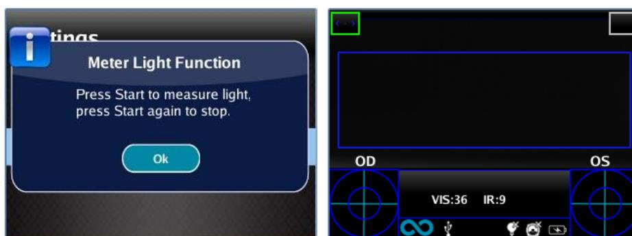
Aguarde o "destaque do círculo etário" desaparecer e leia os valores VIS e IR. VIS e IR representam respectivamente avaliação de luz visível (faixa de 0 a 65535) e avaliação de luz infravermelha (faixa de 0 a 255)
